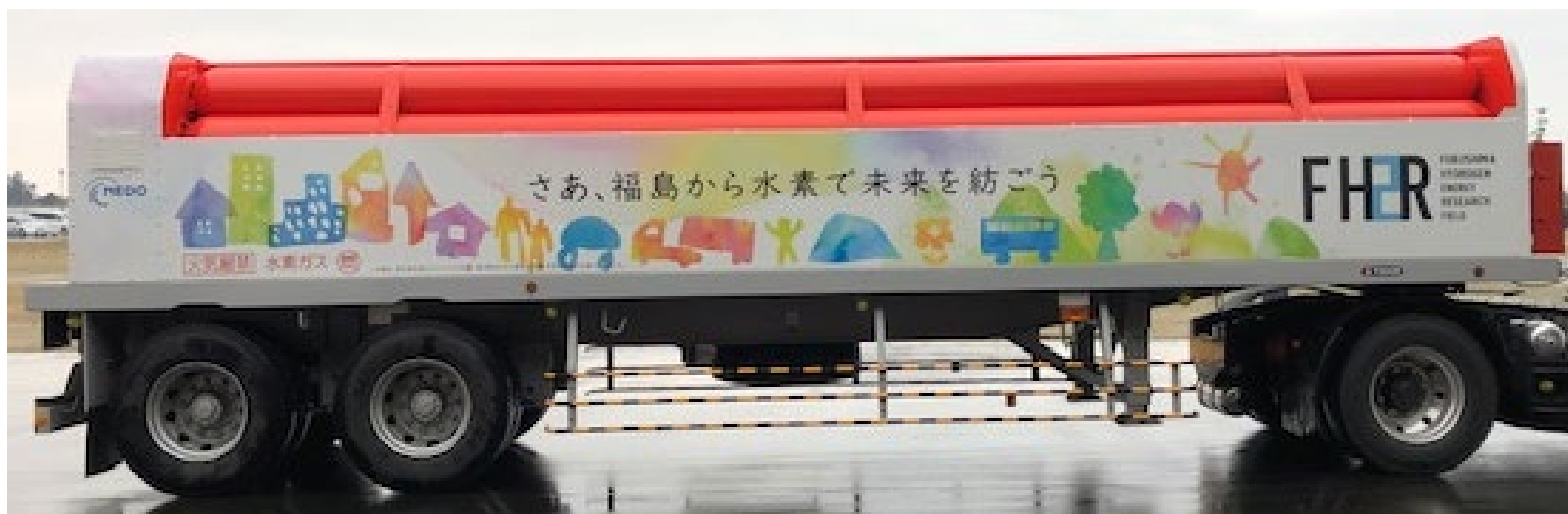
トレーラー（水素貯蔵量：0.237t(2,642 Nm 3 ))
