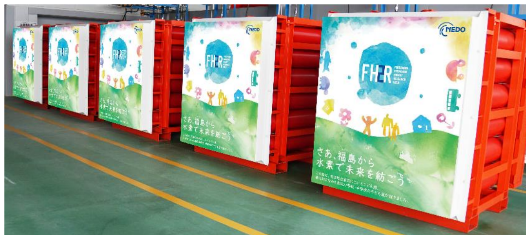
カードル（水素貯蔵量：0.024 t (265.8 Nm 3 ))
