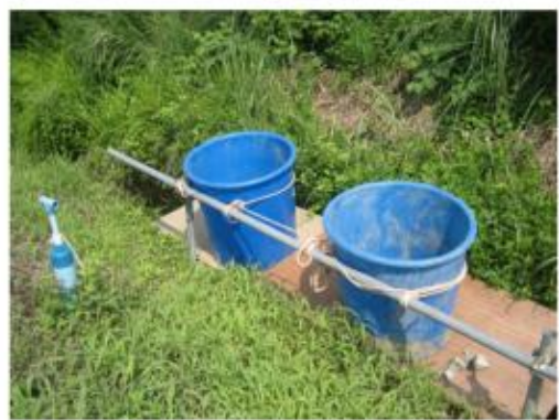
写真-E: 水田 A、B からの排水収納容器
