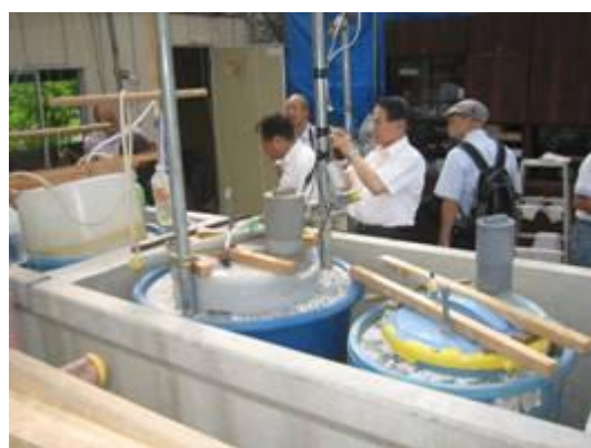
バイオマス発酵装置見学状況(左の容器にメタンガスが溜まっているのが判ります)
