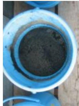
土壌と竹炭を混合攪拌し、2ヵ月静置、自然乾燥後の状態
