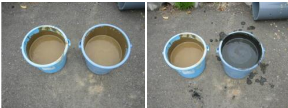
左写真の試料サンプルの右側のバケツ試料に竹炭微粉末を混ぜ込み。この後自然沈殿と乾燥
