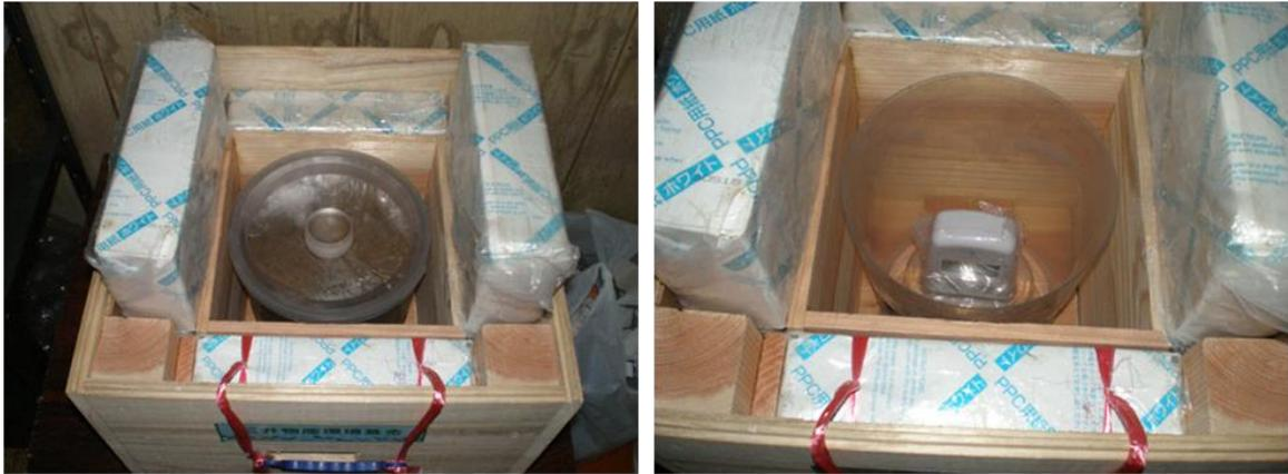
図3-6 空間線量計を用いた簡易放射能測定装置
