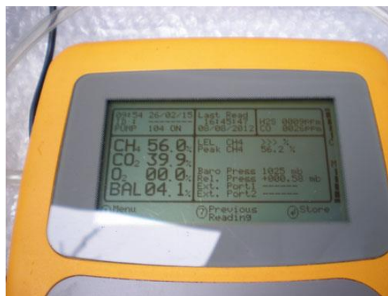
写真 3-2-3 サイレージ化デントコーンのメタン発酵によって発生したバイオガスの分析
