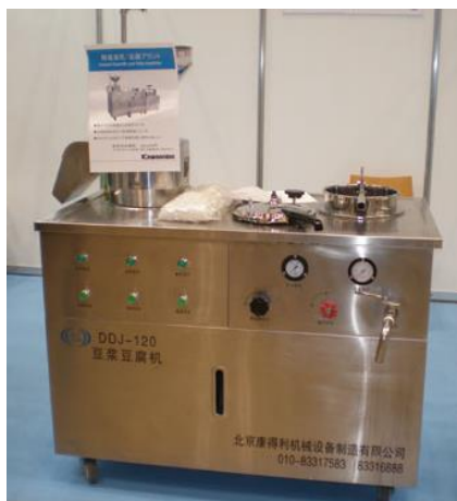
写真 2-3-3 中国のスーパー店頭などで使われている豆腐製造装置
