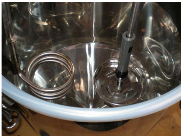
写真 3-9-3 製造装置の内部 (左：ヒーター、 右：攪拌機)
