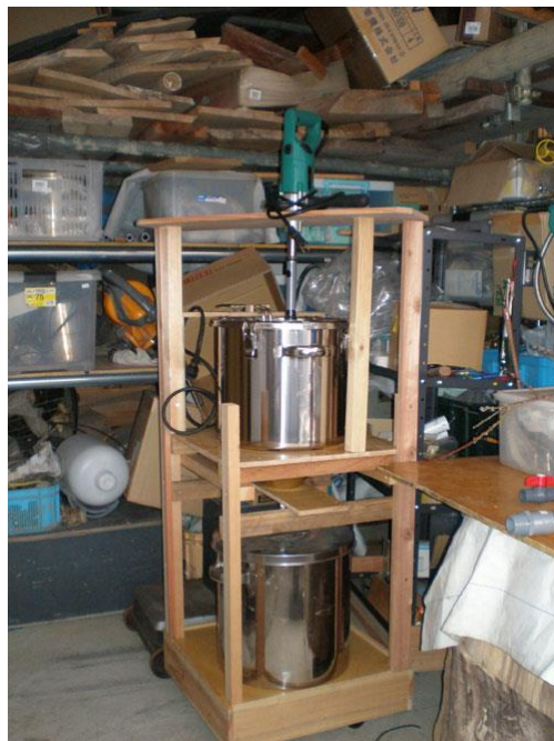
写真 3-9-2 手造りの BDF 製造装置 （自費設置）
