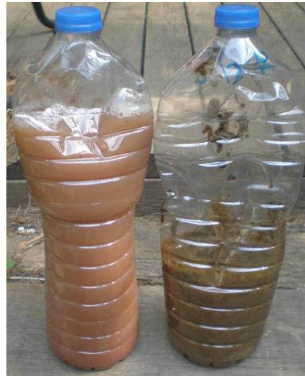
沈降分離後の上澄み液 (左) (消化液) 放射能測定値 Cs134 8.23 Bq/L Cs137 16.3 Bq/L
