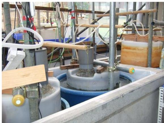
図7 メタン発酵槽とバイオガス貯留タンク
