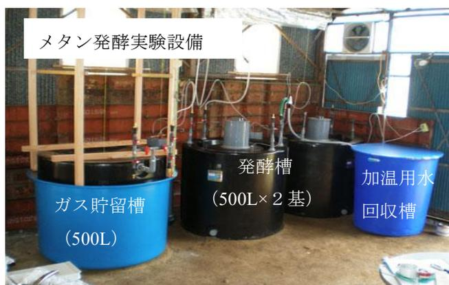
図 15 デントコーンメタン発酵実験装置
