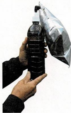
見学に来た人には、ペットボトルに原料を入れたミニ装置でアルミパックにバイオガスを貯め、火をつけて見せる
