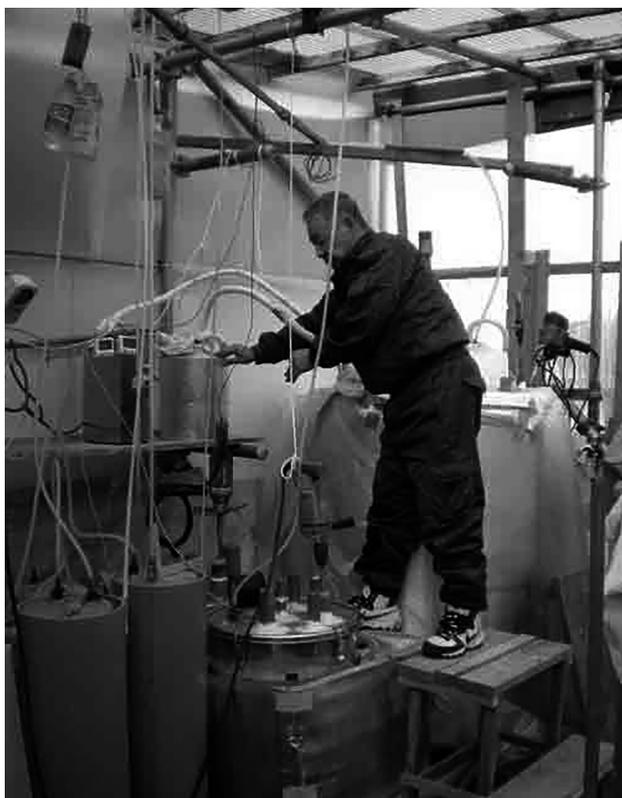
写真1 メタン発酵装置の日常管理
