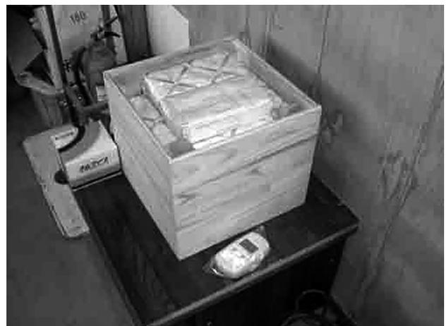
写真4 鉛ブロックで遮蔽した放射能測定器
